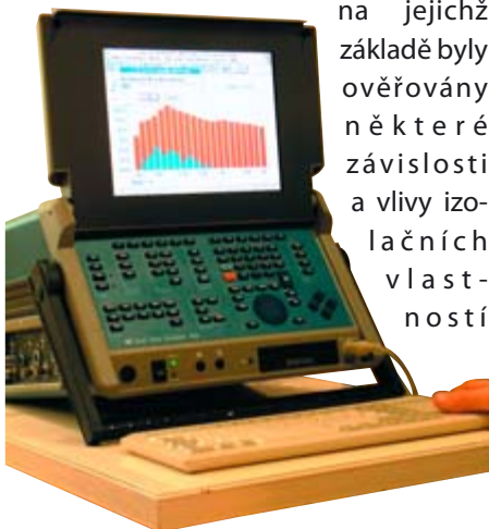
Frekvenční charakteristika měřené příčky přímo zobrazená měřicí aparaturou
